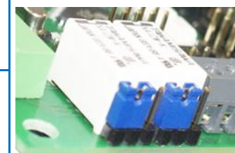
Контакты реле PAS нормально разомкнуты (состояние поставки)
