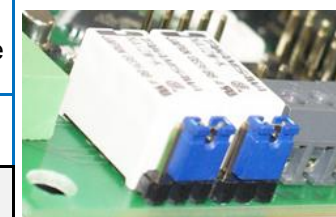
Контакты реле PAS нормально замкнуты
